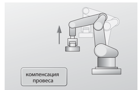
Компенсация силы тяжести для повышения точности позиционирования и фасовки
