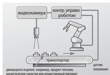
Функция синхронизации перемещения звеньев робота с перемещением захватываемого объекта
