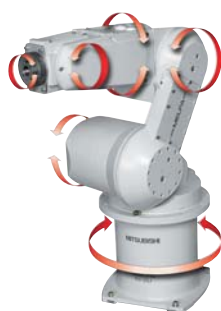
Степени свободы роботов RV-3SDB
