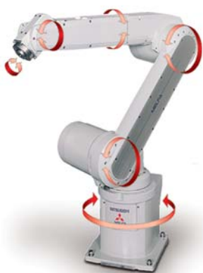
Степени свободы роботов RV-12SDL
