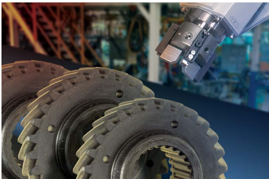
Простое манипулирование тяжелыми грузами – до 12 кг
